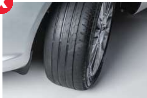
Pneus recauchutados, com deformações, rasgos, gastos irregulares ou qualquer avaria.
