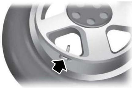
**Nota:** Cada pneu é equipado com um sensor de pressão localizado no interior da roda e da cavidade de montagem do pneu. O sensor de pressão é ligado à haste da válvula. Ele é encoberto pelo pneu e não é visível a menos que o pneu seja removido. Tenha cuidado ao trocar o pneu para evitar danos ao sensor.
