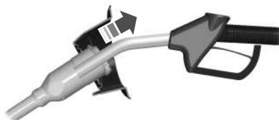
6. Quando houver o corte da bomba, aguarde 5 segundos, levante lentamente o bico da bomba de combustível e o remova com cuidado.
