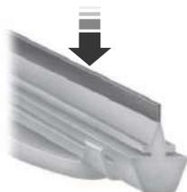
Passe a ponta de seu dedo sobre a extremidade da palheta para verificar se há rugosidades.
