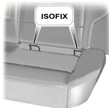
2. Empurre o sistema de fixação de crianças firmemente para trás até encaixar os pontos de fixação ISOFIX inferiores.
