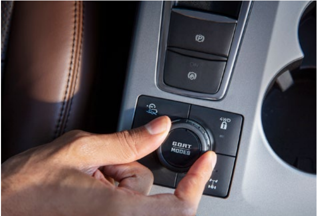
Seletor com 07 tipos de terrenos (G.O.A.T. modes)
