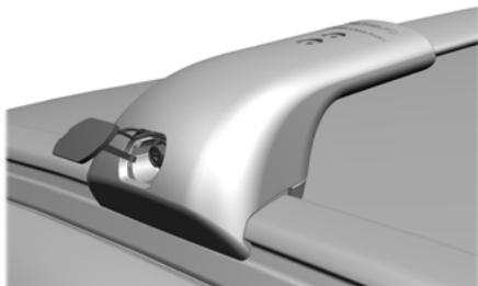
1. Solte o parafuso da barra transversal usando a ferramenta fornecida ou semelhante.
