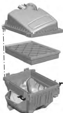
7. Instale um novo elemento do filtro de ar. Tome cuidado para não prender as extremidades do filtro entre a carcaça e a tampa do filtro de ar. Isso pode causar danos ao filtro e permitir que o ar não filtrado entre no motor se ele não estiver devidamente instalado.
