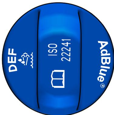
O tubo do bocal de abastecimento de ARLA 32 está próximo do tubo do tanque de combustível e tem uma tampa azul. Abasteça o tanque usando uma bomba de fluido em um posto de abastecimento de ARLA 32 ou um recipiente de ARLA 32.
