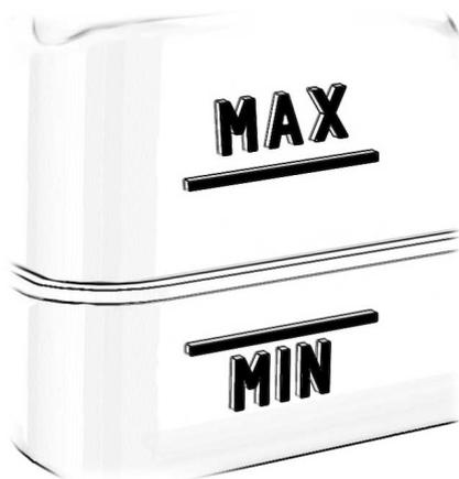
Certifique-se de que o nível do líquido de arrefecimento esteja entre as marcas MIN e MAX no reservatório do líquido de arrefecimento. Se o nível do líquido de arrefecimento estiver na ou abaixo da marca mínima, adicione líquido de arrefecimento imediatamente.
