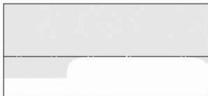
4. Na parede ou no anteparo, você observará uma zona plana de alta intensidade de luz, localizada na parte superior do padrão de feixe. Se a borda superior da zona plana de luz de alta intensidade não está na linha de referência horizontal, ajuste o foco do farol baixo.
