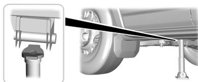
Posicione a cabeça do macaco do veículo sob os parafusos de montagem traseira do subchassi traseiro.
