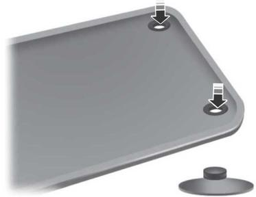
Para instalar os tapetes de assoalho com olhais, posicione o orifício do tapete sobre a coluna de retenção e pressione para baixo a fim de travá-la na posição. Repita para todos os olhais no tapete de assoalho.
