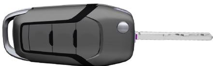
O controle remoto usa uma bateria de lítio do tipo moeda de três volts CR2032 ou equivalente.
