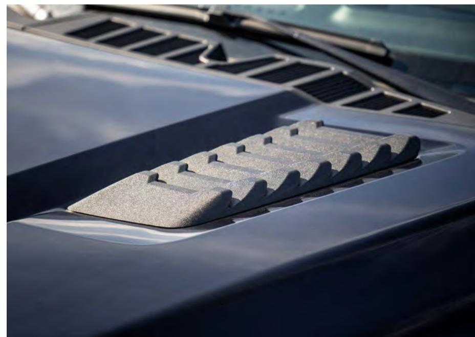
O capô possui saídas de ar projetadas para melhorar a ventilação, especialmente em ambientes off-road extremos, garantindo que o motor opere de forma mais eficiente e resfriada.
