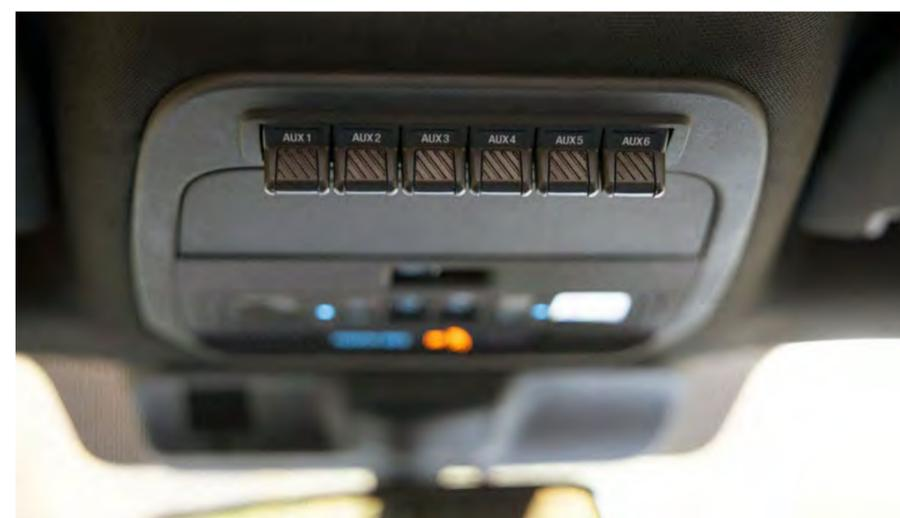
6 interruptores auxiliares com ligação elétrica preparados para acionar seus acessórios off-road.
