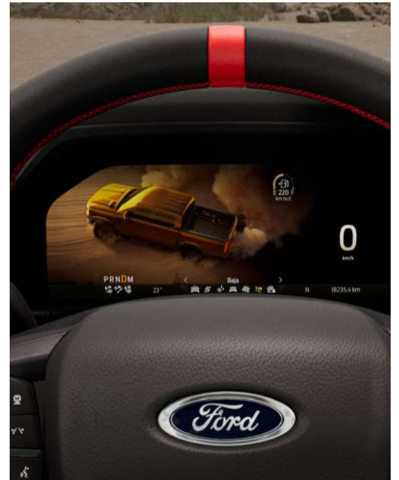
7 modos de condução: Normal, Esportivo, Escorregadio, Lama/Terra, Areia, Baja, Rock Crawl.
