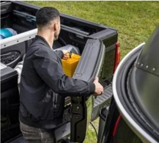
Caçamba revestida com iluminação, tomada 12V, nichos com trava e abertura lateral multiacesso (Pro-Access).
