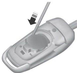
4. Insira uma chave de fenda conforme exibido para liberar a bateria.
