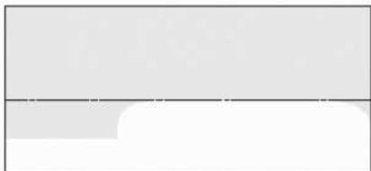
4. Na parede, você vai observar uma zona plana de alta intensidade de luz, localizada na parte superior. Se a extremidade superior da zona de luz de alta intensidade não estiver na linha de referência horizontal, ajuste o farol.
