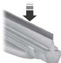
Passes a ponta de seu dedo sobre a extremidade da palheta para verificar se há rugosidades.
