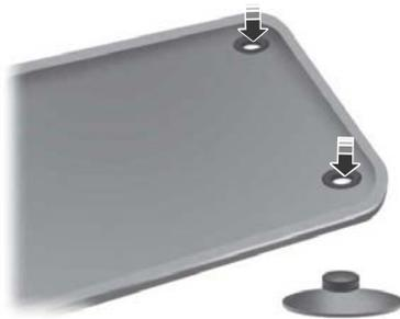
Para instalar os tapetes de assoalho com olhas, posicione o orifício do tapete sobre a coluna de retenção e pressione para baixo a fim de travá-la na posição. Repita para todos os olhas no tapete de assoalho.
