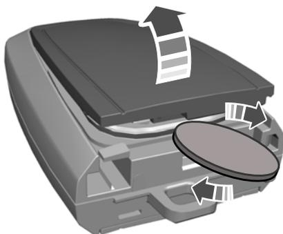
2. Gire uma moeda fina embaixo da aba escondida atrás da cabeça da chave da lâmina para remover a tampa da bateria.
