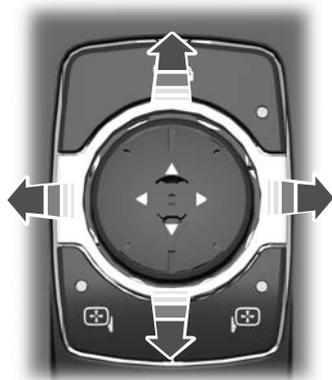
Para ajustar os retrovisores, ligue o veículo com a ignição em modo acessório ou o motor em funcionamento.
