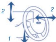
Alavanca de ajuste da posição do volante
