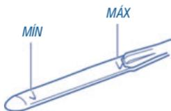
O nível do líquido deve ser mantido entre as marcas MÍN e MÁX, na lateral do reservatório.
