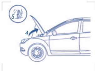
Levante a tampa totalmente e apóie-a na haste de sustentação (4), encaixando no retentor, certificando-se de que esteja bem segura (5).
