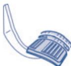
Se acelerar o veículo pressionando o pedal do acelerador, a velocidade definida não sofre alteração. Ao soltar o pedal do acelerador a velocidade pré-definida retomar.
