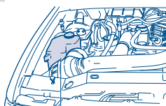
Reservatório do líquido de arrefecimento do motor à gasolina
