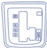
**Se ao abrir a porta do motorista, com o motor desligado e a alavanca de mudanças não estiver na posição P (estacionamento) será emitido um aviso sonoro alertando sobre o posicionamento da alavanca. O aviso sonoro será desativado para economia da bateria depois de um determinado período de tempo.**
