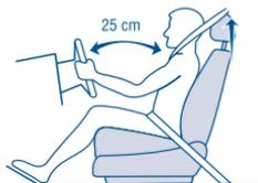
Use o cinto de segurança e mantenha uma distância mínima de 25 cm entre o volante e o peito do motorista para reduzir o perigo de ferimento por proximidade excessiva do *air bag* quando este é inflado. O mesmo se aplica para o passageiro da frente.
