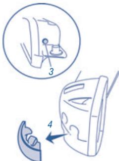
3. Com uma ferramenta adequada, solte o clipe de fixação. Desmonte a lâmpada e o soquete.
