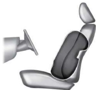
Os airbags laterais foram projetados para inflar entre o painel da porta e o ocupante a fim de aumentar a proteção em determinadas colisões.
