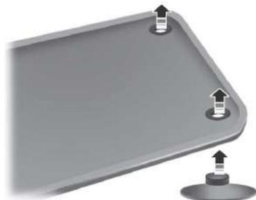
Para instalar os tapetes, posicione o orifício do tapete sobre a haste de fixação e pressione para baixo para travá-lo na posição.
