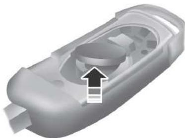
**Nota:** Não toque nos contatos da bateria ou na placa de circuito impresso com a chave de fenda.
