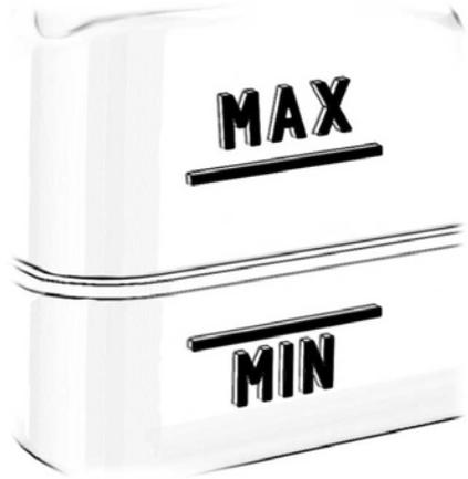
Certifique-se de que o nível do líquido de arrefecimento esteja entre as marcas MIN e MAX no reservatório do líquido de arrefecimento. Se o nível do líquido de arrefecimento estiver na ou abaixo da marca mínima, adicione líquido de arrefecimento imediatamente.
