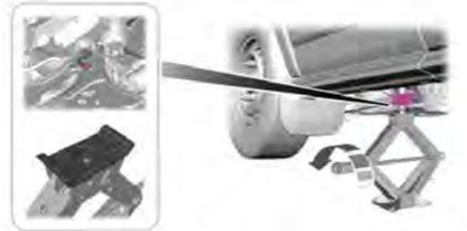
Posicione a cabeça do macaco do veículo sob os parafusos de montagem traseira do subchassi traseiro.
