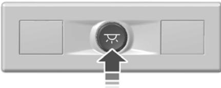
Pressione o botão no console de teto para acender e apagar todas as luzes internas ou de emergência.
