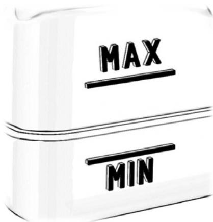
Caso o nível do fluido de direção hidráulica esteja abaixo da marca **MAX**, adicione um fluido de direção hidráulica que atenda à especificação correta.
