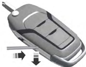
2. Insira uma ferramenta adequada (por exemplo, uma chave de fenda) na posição exibida e empurre o grampo delicadamente.
