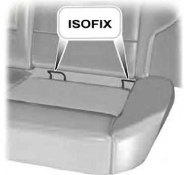
3. Empurre o sistema de fixação de crianças firmemente para trás até encaixar os pontos de fixação ISOFIX inferiores.
