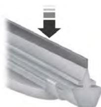
Passa a ponta de seu dedo sobre a extremidade da palheta para verificar se há rugosidades.
