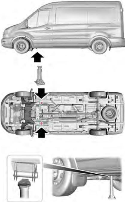
Posicione a cabeça do macaco do veículo sob as protuberâncias na traseira do subchassi dianteiro.
