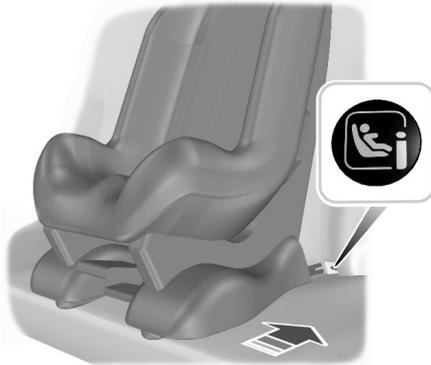
O sistema ISOFIX possui dois braços rígidos de fixação no dispositivo de fixação para crianças. Eles são presos nos pontos de retenção dos bancos traseiros externos no ponto de encontro entre o assento e o encosto.
